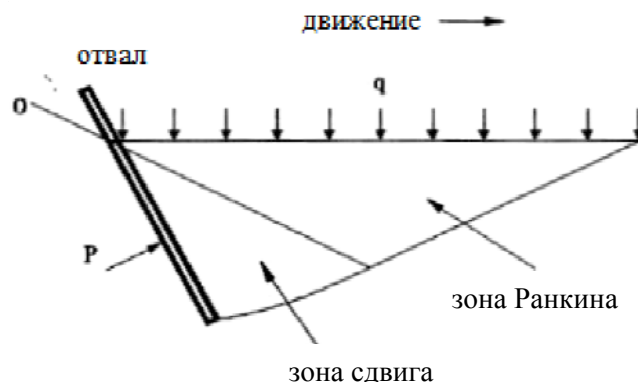
Рис. 3. Зона логарифмического спирального разрушения
