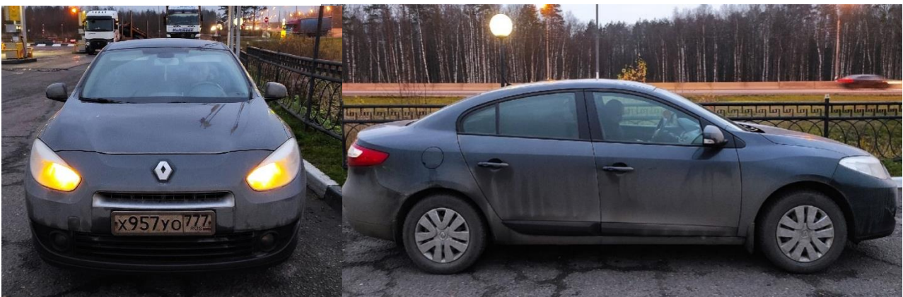
Рис. 1. Автомобиль Renault Fluence - 1,6 л, емкость бака 60 л, расход топлива, л/100 км: городской цикл - 8,8; загородный цикл - 5,3; смешанный цикл - 6,5
