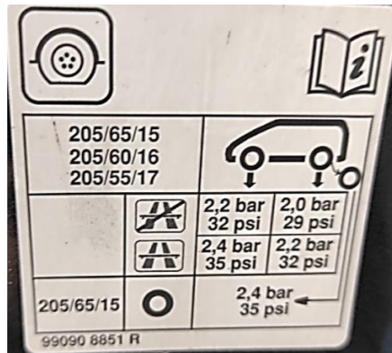
Рис.2. Рекомендуемые производителем размерности шин и величины давления в них
