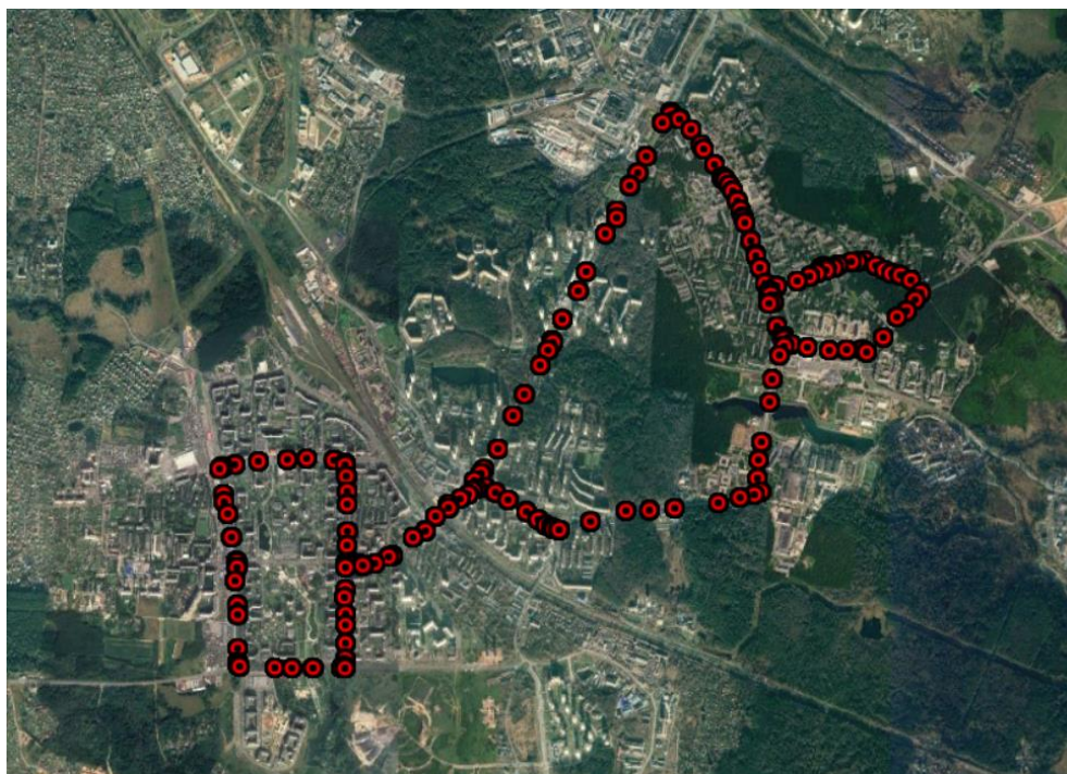
Рис. 4. Наложение данных с GPS датчика смартфона на карту Google Earth
