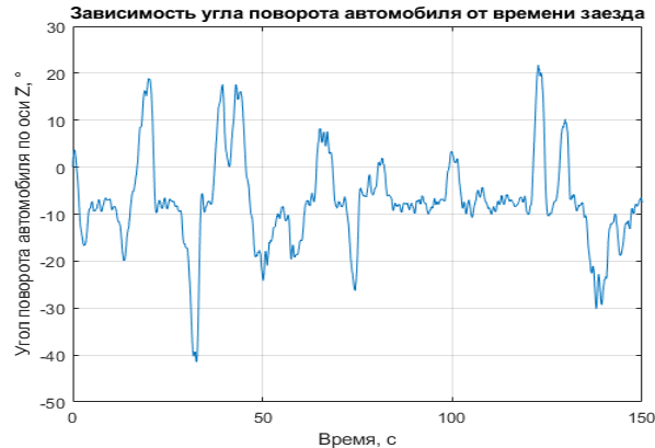
Рис. 6. Зависимости углов поворота автомобилей относительно оси Z от времени заезда, а) Lada Vesta SV Cross; б) Ford Focus
