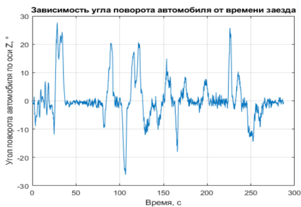
Рис. 6. Зависимости углов поворота автомобилей относительно оси Z от времени заезда, а) Lada Vesta SV Cross; б) Ford Focus
