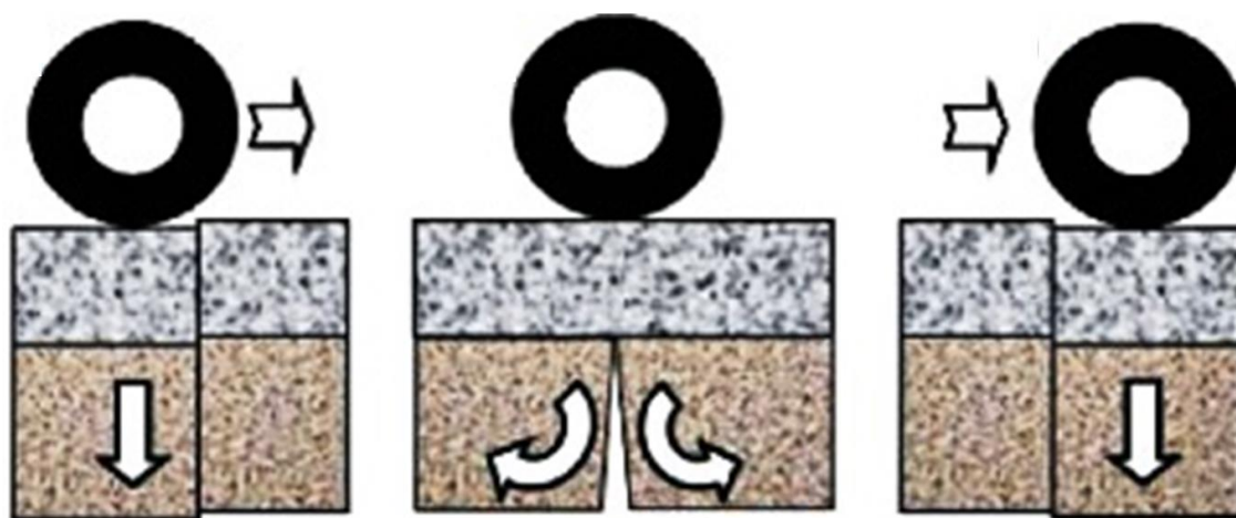
Рис. 2. Механизм образования отраженных трещин вследствие воздействия нагрузки транспортных средств
