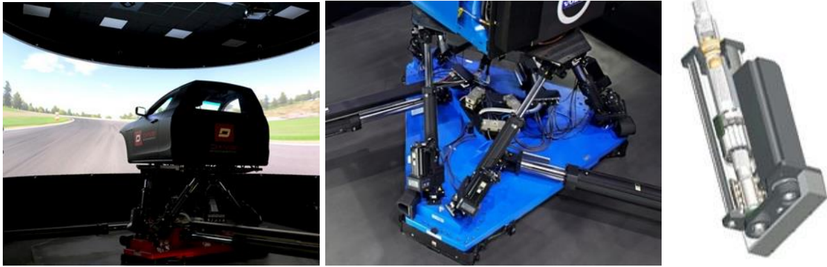
Рис. 1. – Имитационное моделирование автомобиля в стендовых условиях и конструкция электроактуатора
