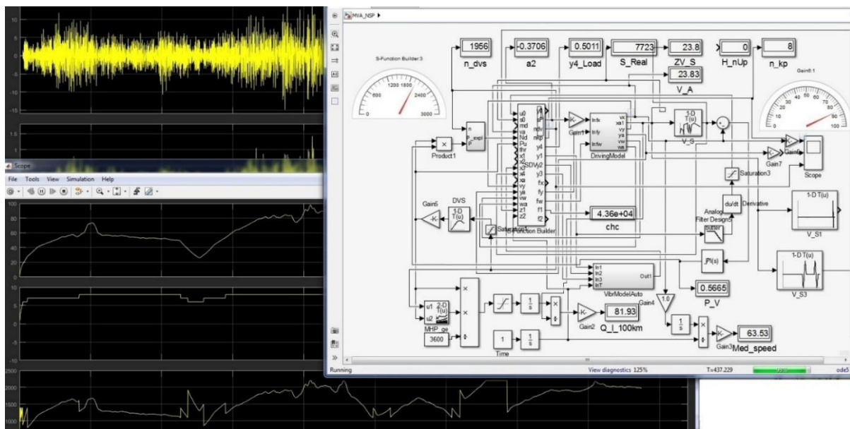
Рис. 5. – Процесс и блок-схема моделирования движения, колебаний и управляемости автомобиля
