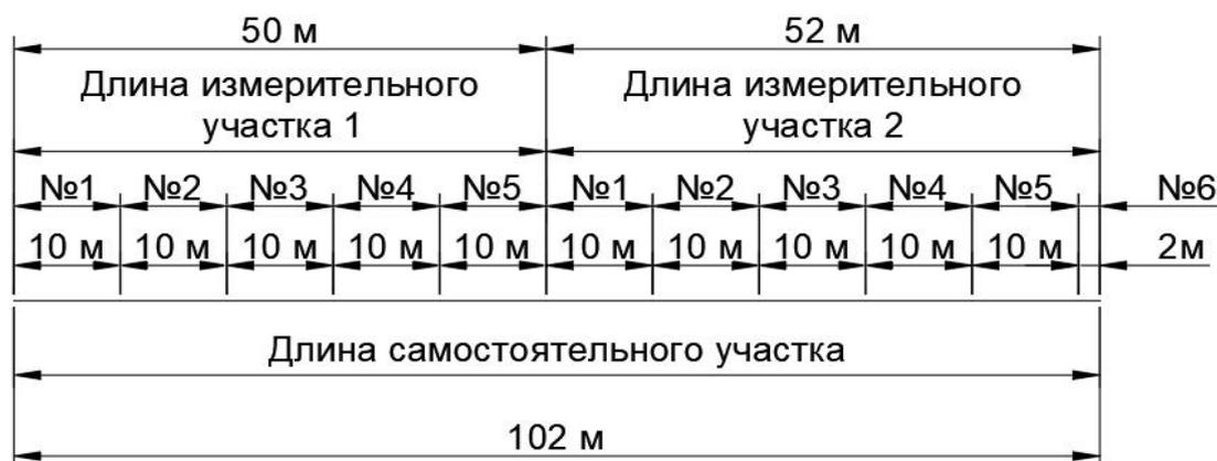
Рис. 3. Разбивка самостоятельного участка на измерительные.
