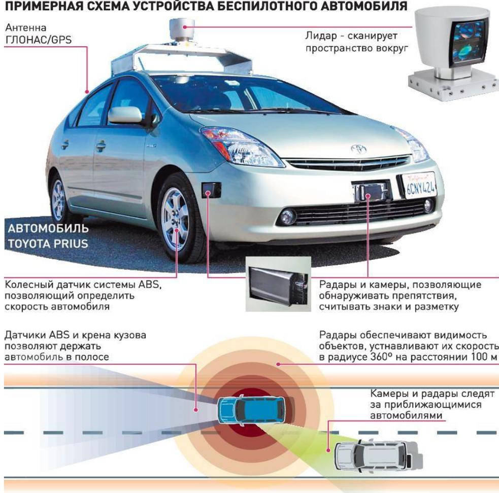
Рис. 1. Примерная схема устройства беспилотного автомобиля
