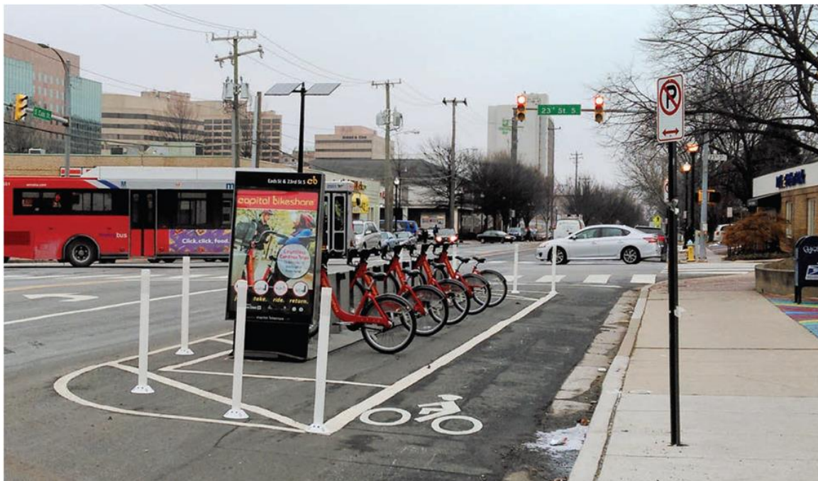
Рис. 4. Станция велошеринга, используемая также для защиты велополосы от автотранспорта. Арлингтон, штат Вайоминг, США
