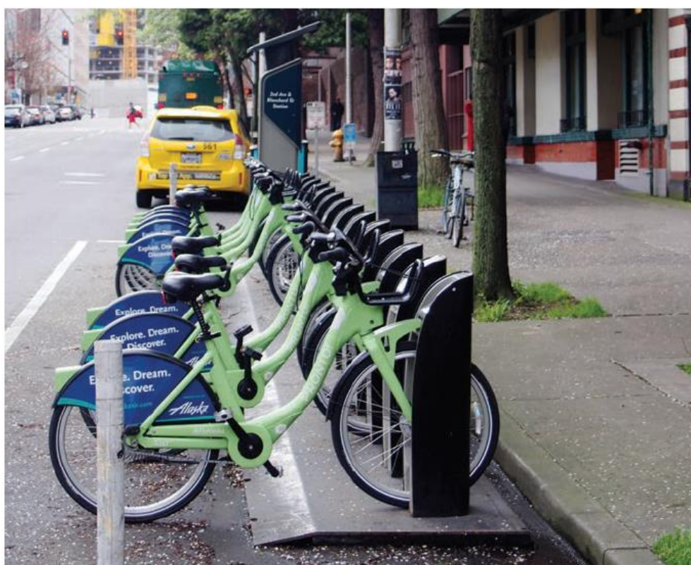
Рис. 3. Станция велошеринга, располагаемая на уличной автомобильной парковке; велосипеды пристыковываются со стороны проезжей части. Сиэтл, штат Вашингтон, США
