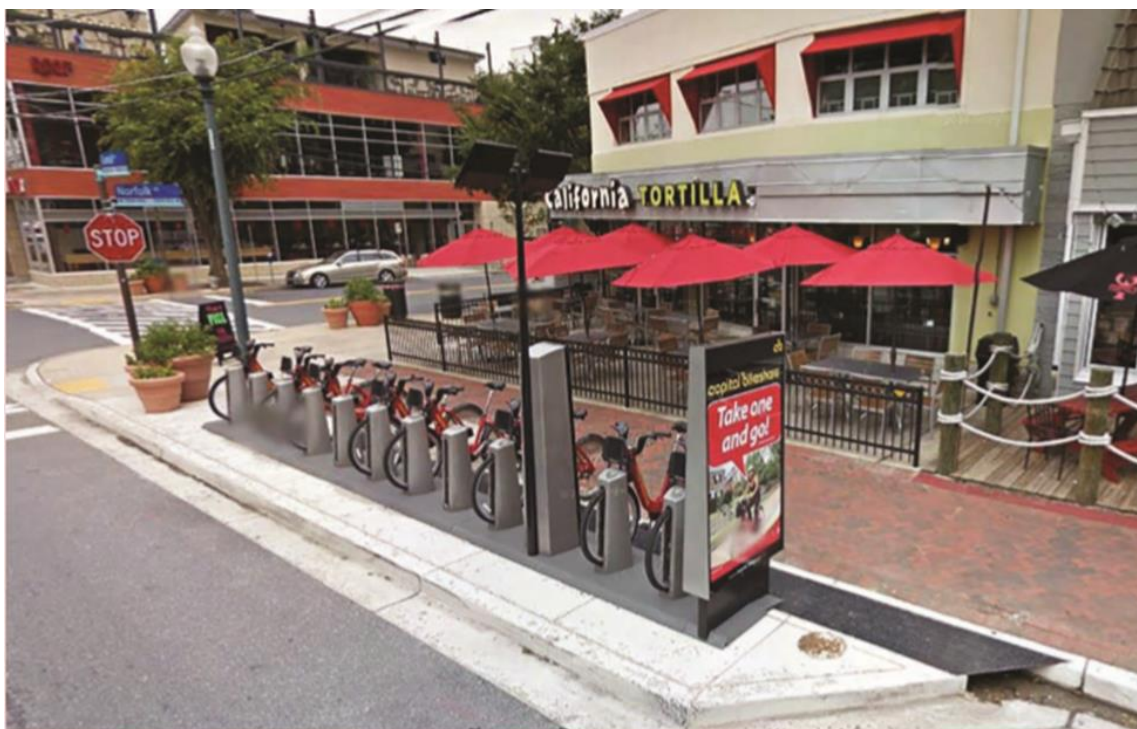
Рис. 2. Станция велошеринга, расположенная на выступе тротуара; велосипеды пристыковываются со стороны тротуара. Бетесда, штат Мериленд, США
