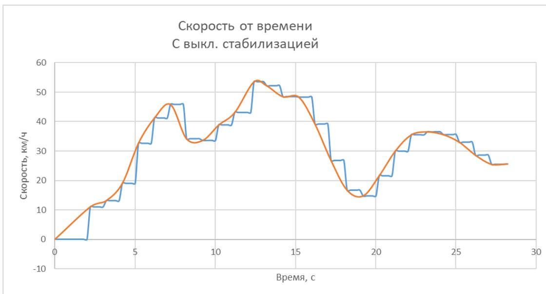
Рис. 6. График скорости движения после обработки
