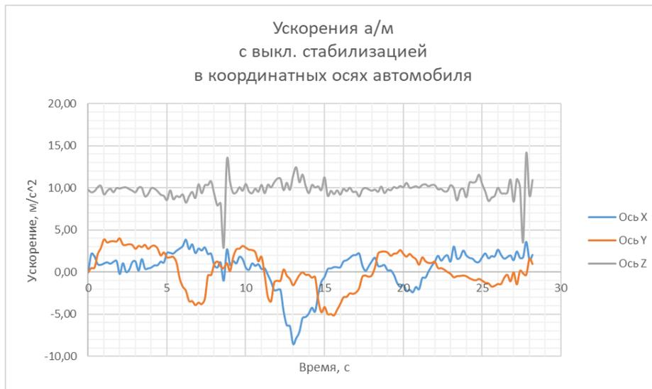
Рис. 8. Графики проекций ускорения в координатных осях объекта испытаний
