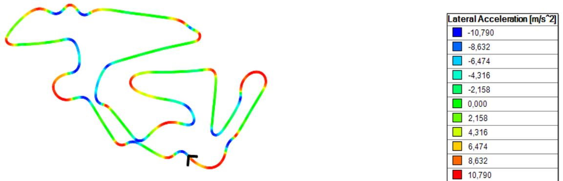
Рис. 12. Боковые ускорения, развиваемые шасси при прохождении трассы.
