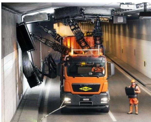
Рис. 7. Тоннелемочная машина фирмы Colas Switzerland
