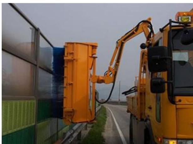
*Рис. 2. Тоннелемоечная машина YDTC0820*
