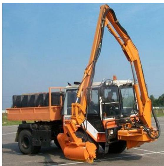
*Рис. 3. Оборудование OPC-20.10 на шасси «Беларус» Ш-406*
