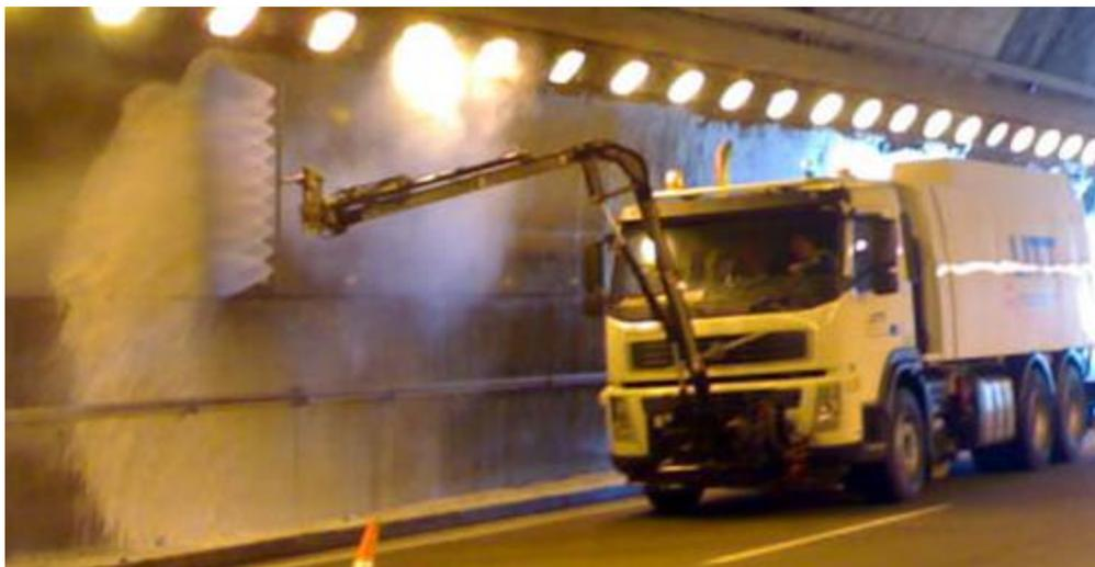
*Рис. 6. Тоннелемоечная машина Johnston VT800*
