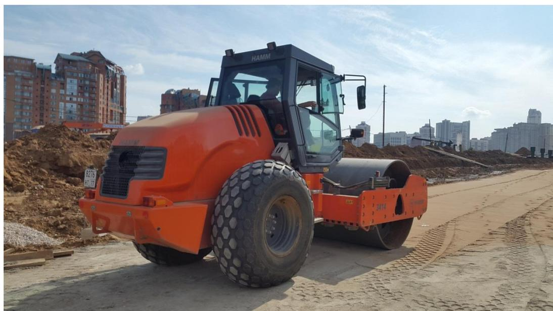
*Рисунок. Грунтовый вибрационный каток производства Hamt
