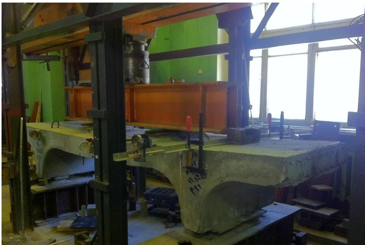
*Фото 1. Натурные испытания плиты проезжей части*
