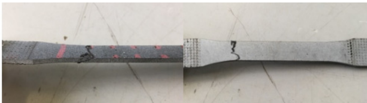
Рис. 12. Образец после испытания на растяжение
