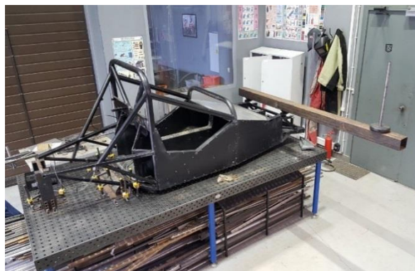
Рис. 25. Стенд с зафиксированной рамой
