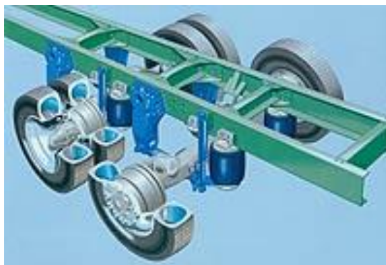
Рис. 11. Пневматическая зависимая подвеска Scania
