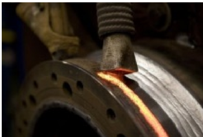
Рис. 2. Электродуговая наплавка под слоем флюса
