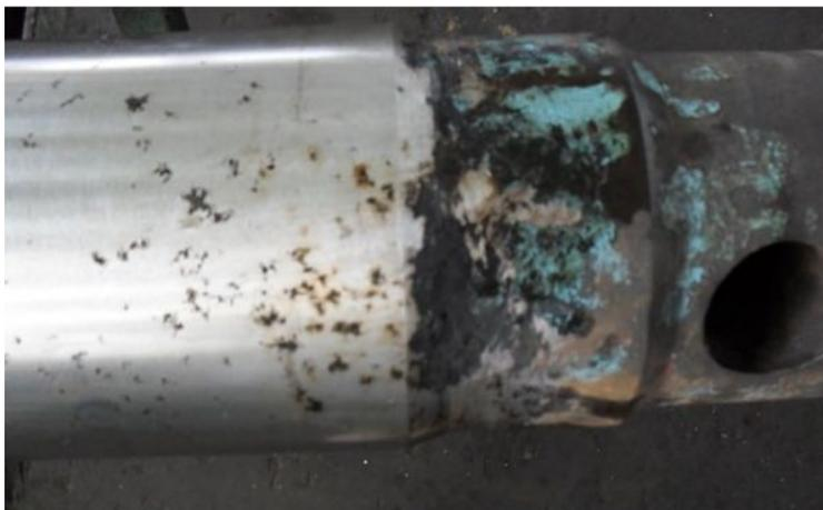
*Рис. 4. Повреждение мест соединения и коррозия на штоке гидроцилиндра*
