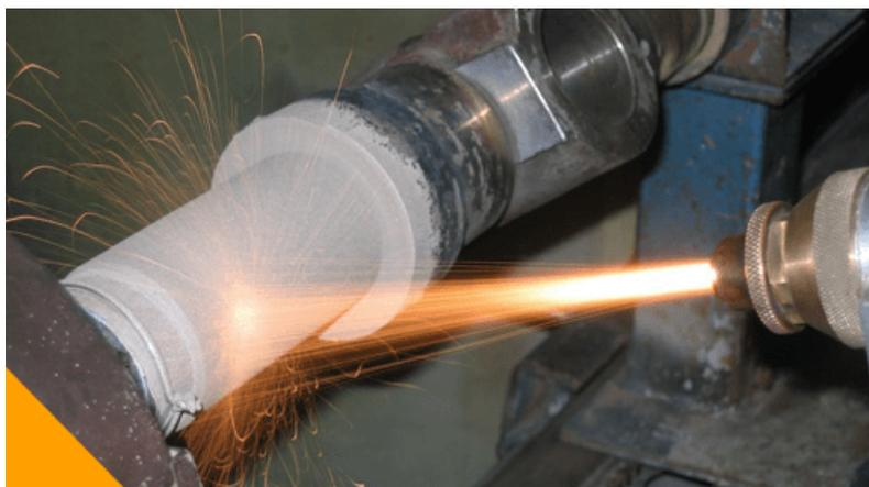
*Рис. 6. Газопламенное напыление металла*
