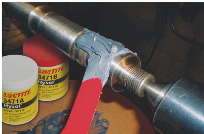
*Рис. 7. Нанесение эпоксидного клея Loctite*
