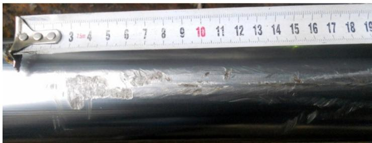
*Рис. 1. Задиры на штоке гидроцилиндра*
