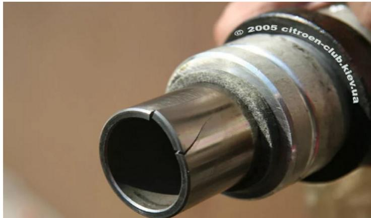
*Рис. 2. Трещина на штоке гидроцилиндра*
