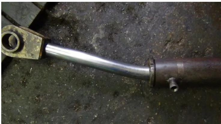
*Рис. 3. Изгиб на штоке гидроцилиндра*
