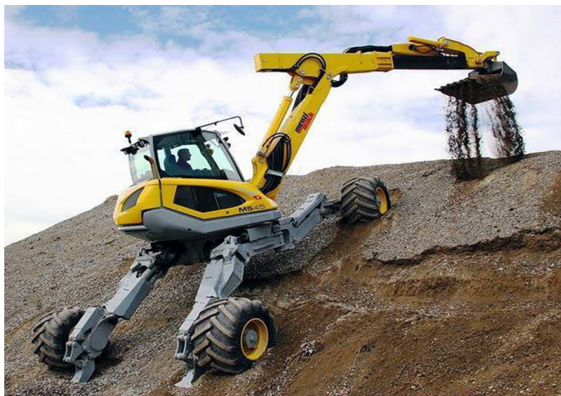
Рис. 4. Экскаватор шагающий Menzi Muck M545
