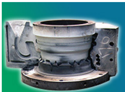
Рис. 3. Литейная форма с отливкой колеса методом гравитационного литья традиционным способом
