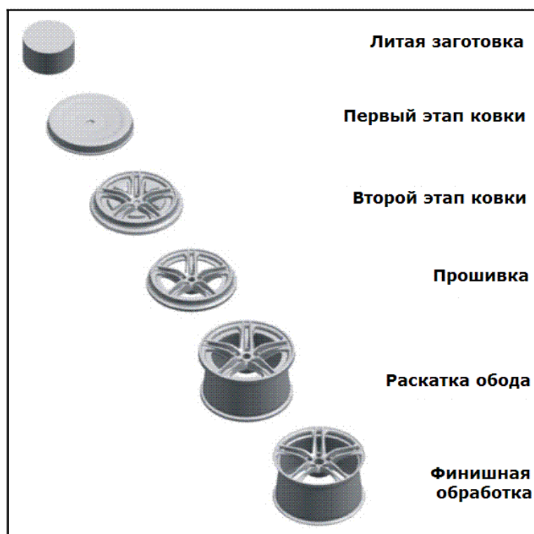
Рис. 11. Технологическая цепочка изготовления облегченных дисковых колес на фирме Otto Fuchs (источник – фирма Otto Fuchs)
