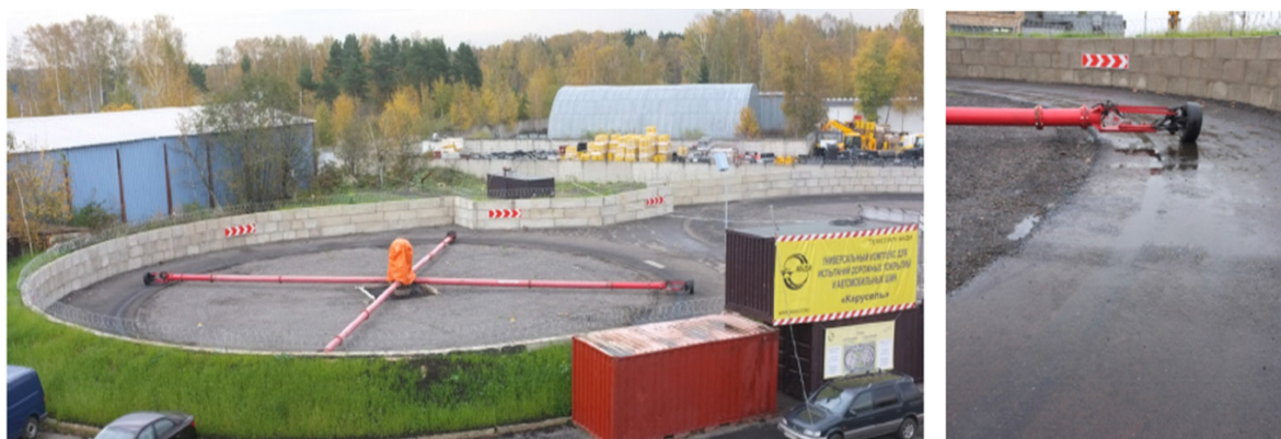
Рис. 2. Универсальный комплекс для испытания дорожных покрытий и автомобильных шин на полигоне МАДИ
