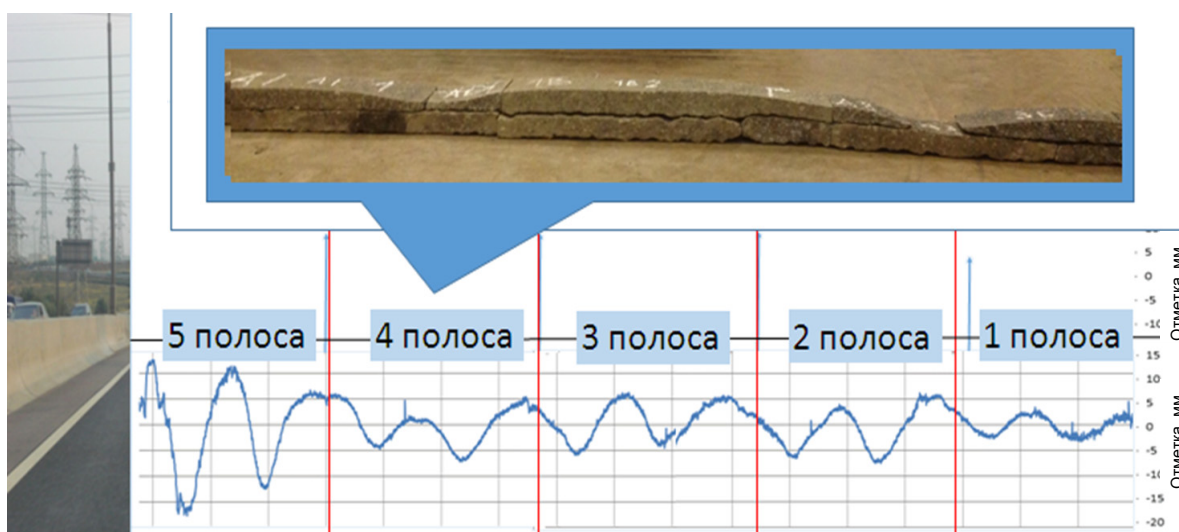
Рис. 1. Образец, отобранный из покрытия на МКАД после 1,5 лет эксплуатации
