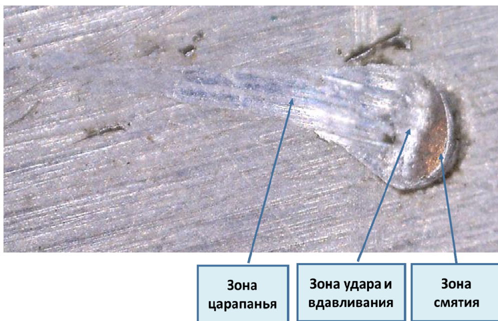
Рис. 3. Особенности взаимодействия шипа с дорожным покрытием
