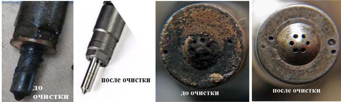
*а – форсунки дизельного двигателя;*
