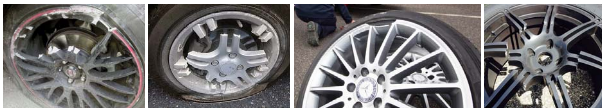
Рис. 2. Эксплуатационные разрушения литых алюминиевых колес легковых автомобилей
