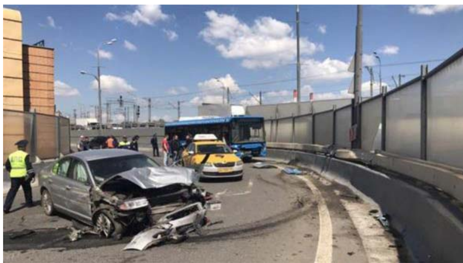
Рис. 1. Авария из-за разрушения алюминиевого колеса при наезде на бордюр
