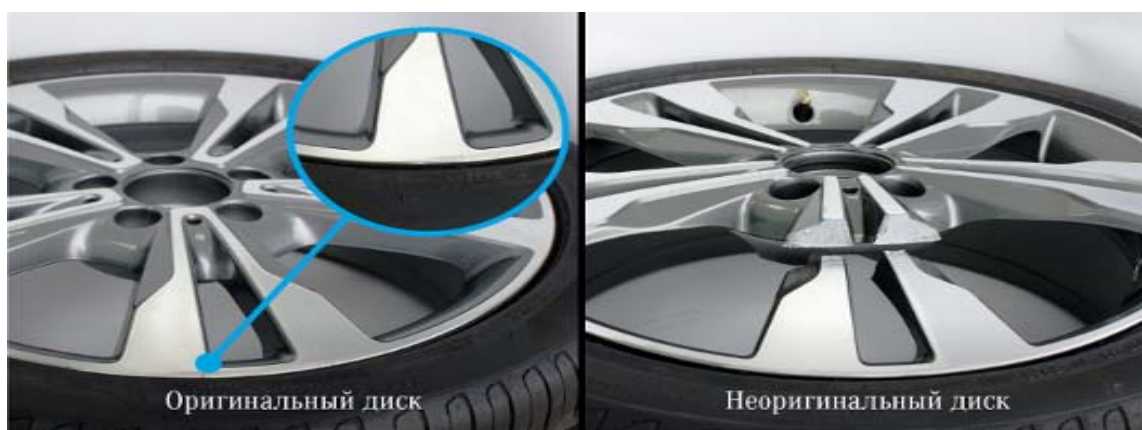
Рис. 6. Результат испытаний на удар под углом 13° оригинального колеса и так называемой «реплики»
