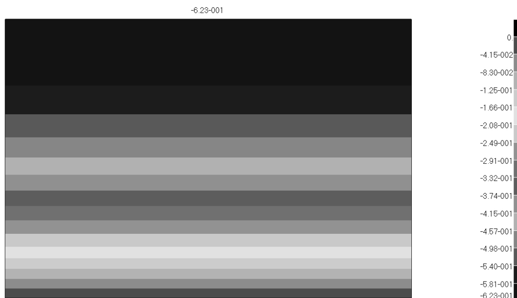
Рис. 1. Поля вертикальных перемещений грунтового массива по результатам первого этапа расчета
