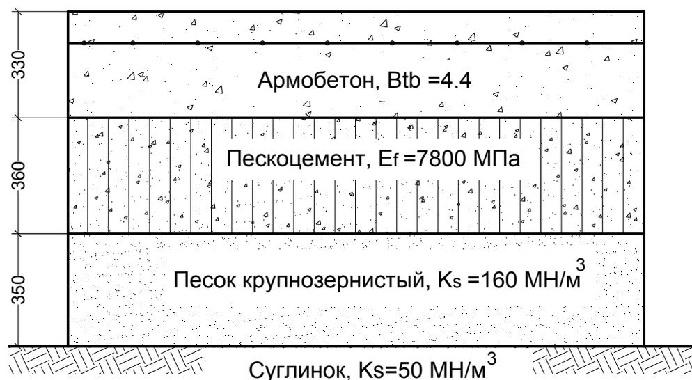
Рис. 2. Конструктивный разрез аэродромного покрытия
