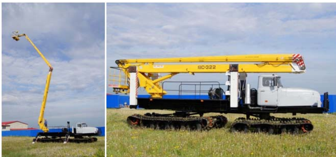
Рис. 9. Машина на двухзвенном 4-гусеничном шасси ТС-АГП с автогидроподъемником
