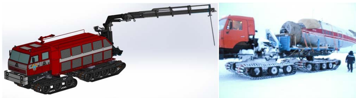
Рис. 5. Машина ТСК – КМУ с бортовой площадкой и гидроманипулятором
