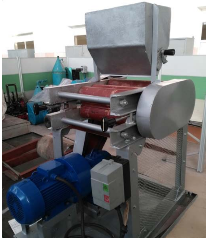
Рис. 2. Лабораторный образец валковой дробилки с выпукло-вогнутым профилем валков
