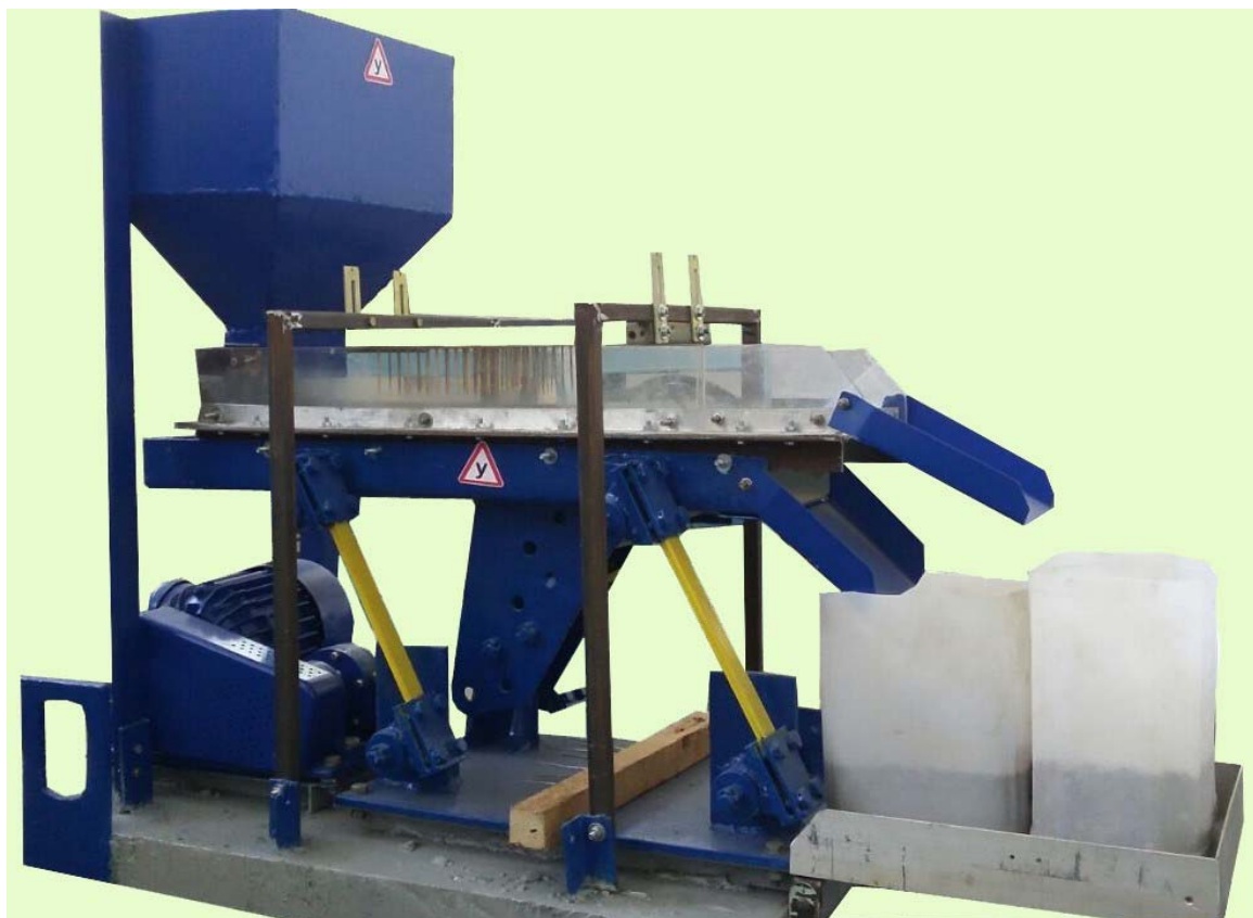
Рис. 4. Экспериментальная установка нового вибрационного грохота
