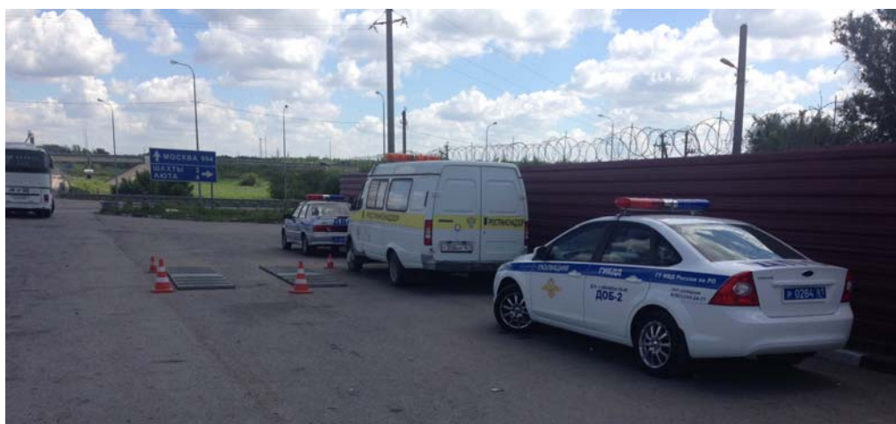
Рис. 1. Мобильный пункт весового контроля на федеральной автомобильной дороге М4 «Дон»
