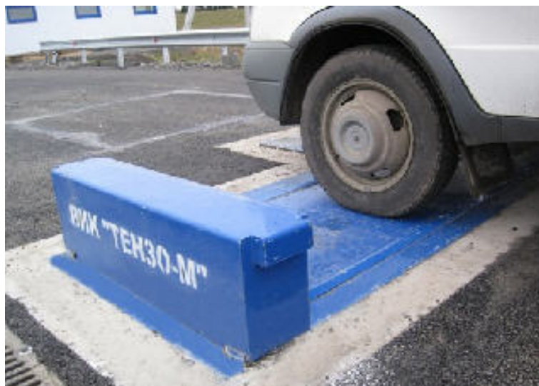
Рис. 8. Процесс контрольного поосного взвешивания на стационарном пункте весового контроля (СПВК)
