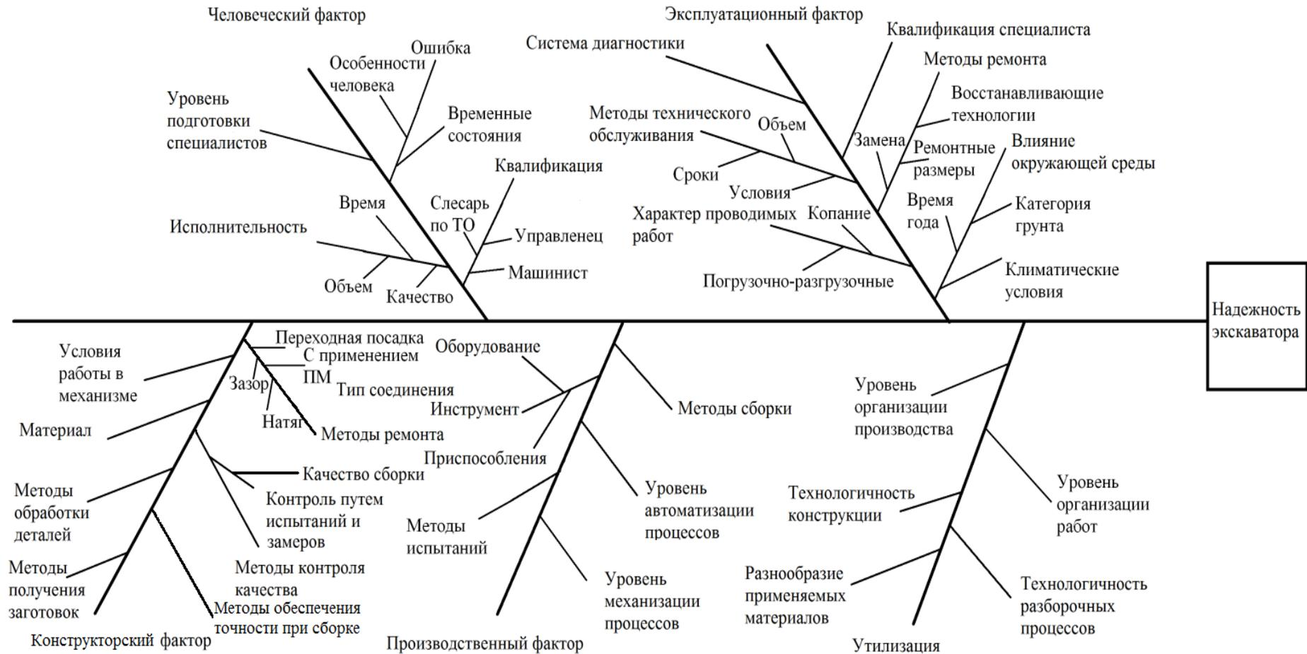
Рис. 1. Факторы, оказывающие влияние на надежность и работоспособность экскаватора
