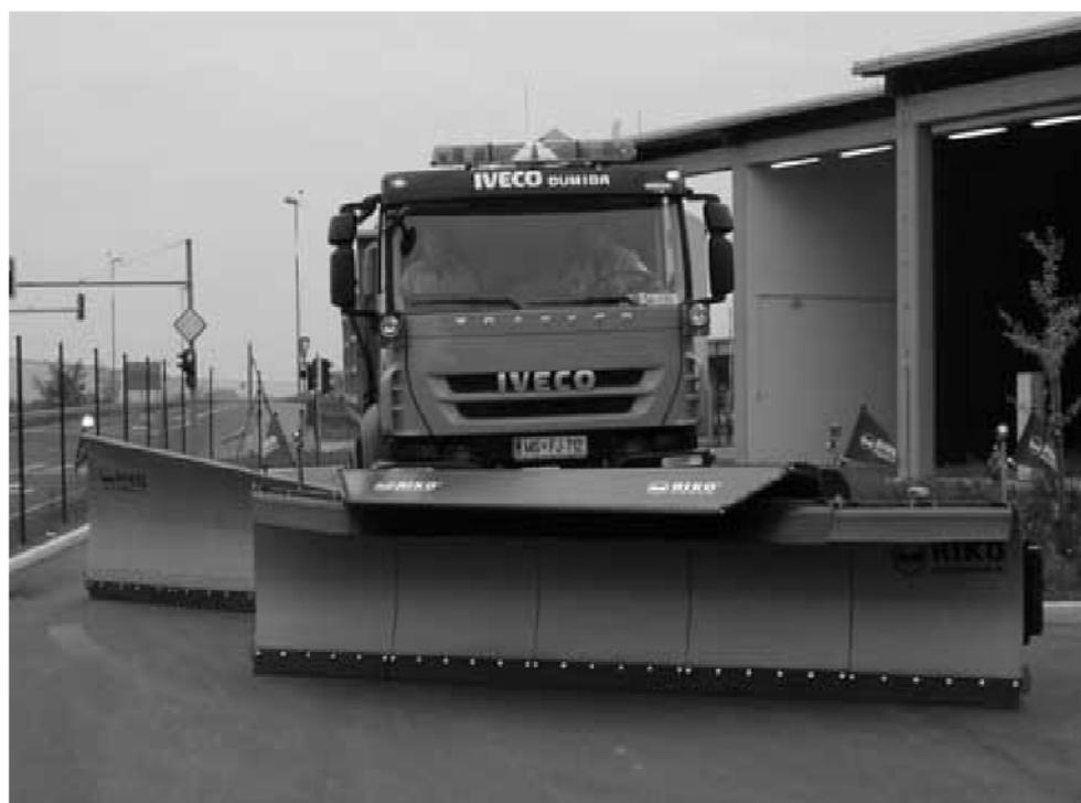
*Рис. 6. Отвал многосекционный ТОМЕЗ серия RPS*
