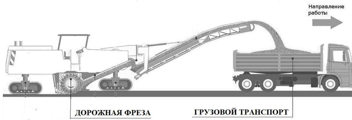
Рис. 2. Схема работы самоходной дорожной фрезы в комплекте с транспортирующей материал машиной
