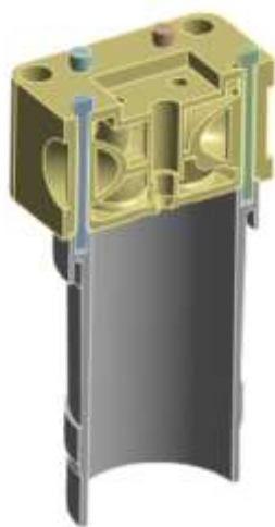
Рис. 2. «Твердотельная» модель сборки втулки с крышкой цилиндра и локальной полостью охлаждения
