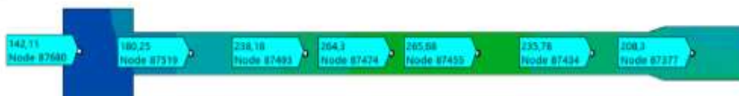
Рис. 10. Поля температур «горячей» шпильки узла при установке стального экрана в зазор между шпилькой и стенкой полости
