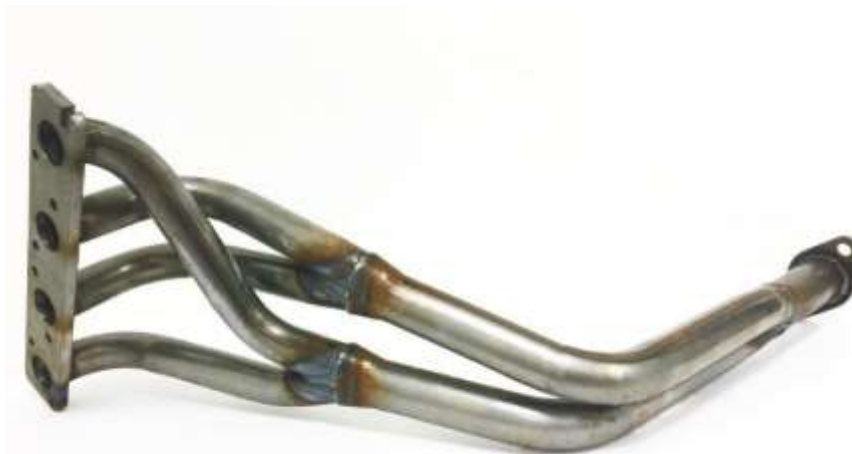
Рис. 2. Модернизированный выпускной коллектор
