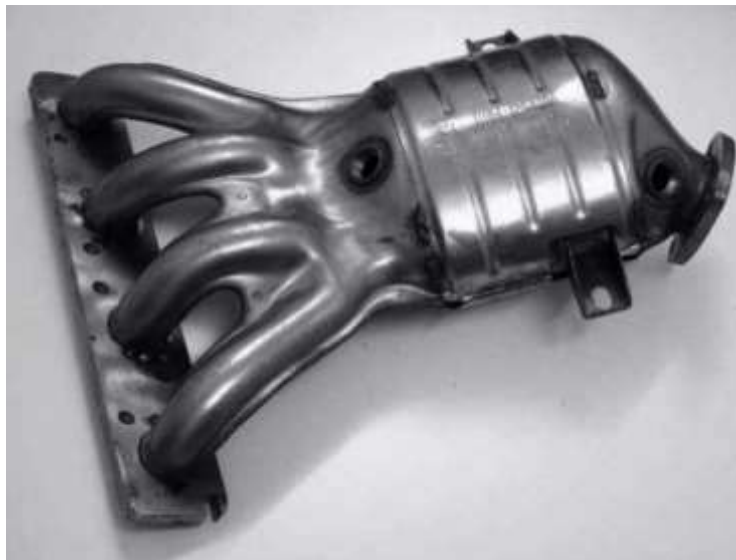
Рис. 1. Стандартный выпускной коллектор с нейтрализатором двигателя ВАЗ-21126
