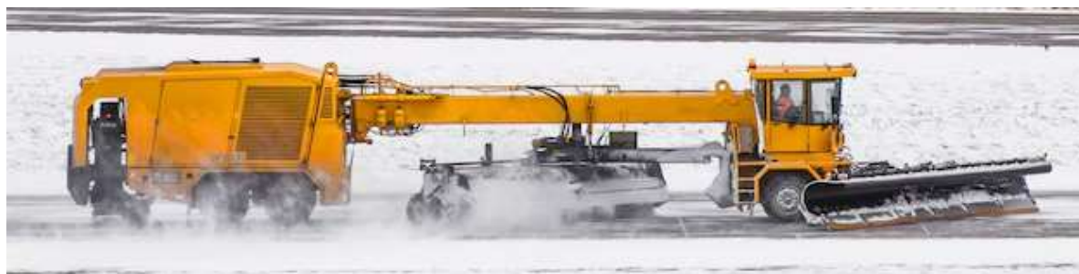
Рис. 1. Плужная щеточно-продувочная машина на одноосном тягаче Vattas
