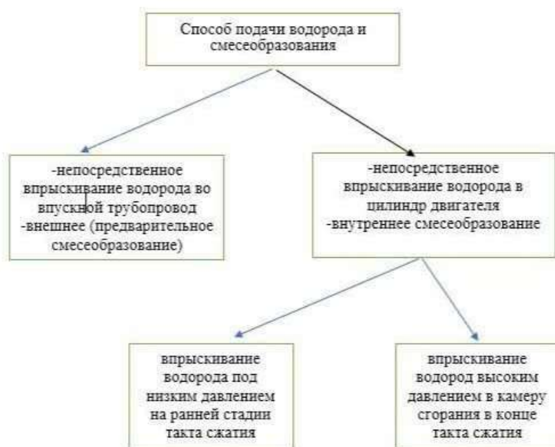
Рис. 5. Способ подачи водорода и смесеобразования
