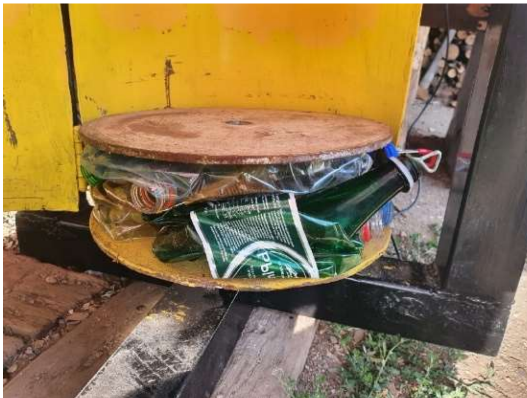
Рис. 2. Прессование пластиковых отходов при осевом сжатии
