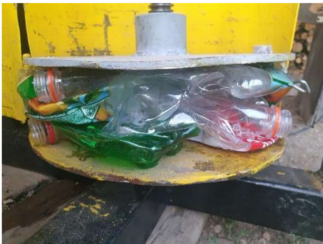
Рис. 2. Прессование пластиковых отходов при осевом сжатии
