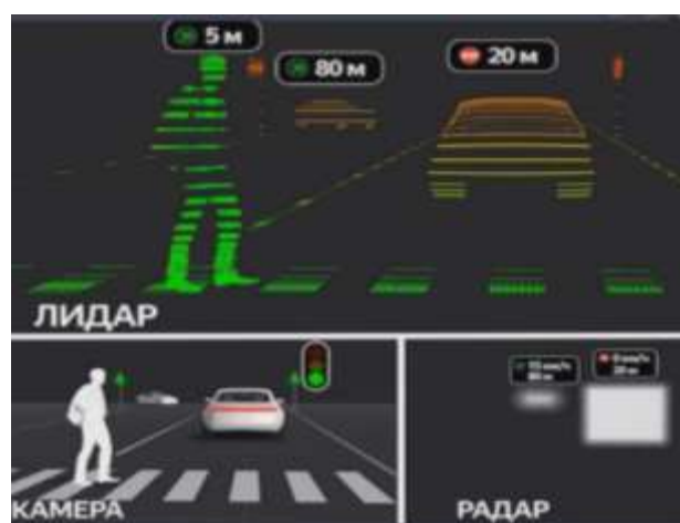
Рис. 2. Сравнение полученного изображения с лидара, камеры и радара
