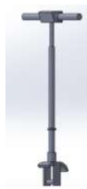
Рис. 10. Рулевой механизм: а – реальный вид; б – ручка руля; в – вилка ведущего колеса; г – переднее крыло; д – 3D-модель рулевого механизма
