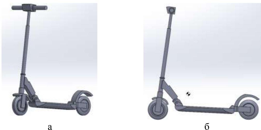
Рис. 11. 3D-модель электросамоката KigooS3; а – сборочная 3D-модель; б – расположение центра масс
