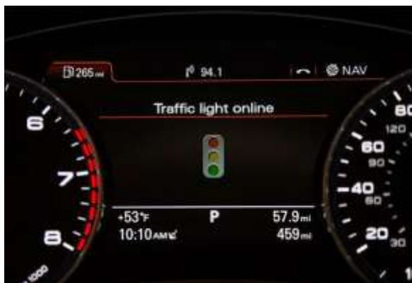
Рис. 4. Система Audi Travolution выводит на экран рекомендуемую скорость
