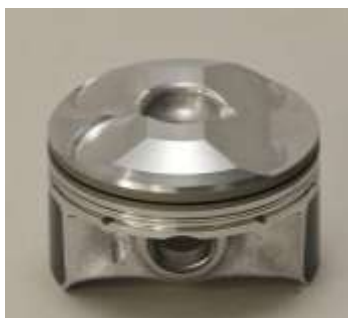
Рис. 1. Поршень двигателя Skyactiv-G с выемкой
