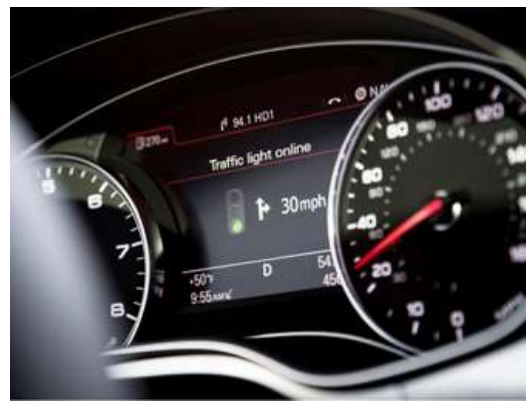
Рис. 4. Система Audi Travolution выводит на экран рекомендуемую скорость
