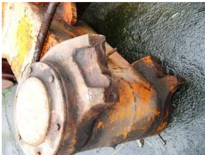
Рис. 1. Сломанный нижний рычаг подвески СМТС [4]
