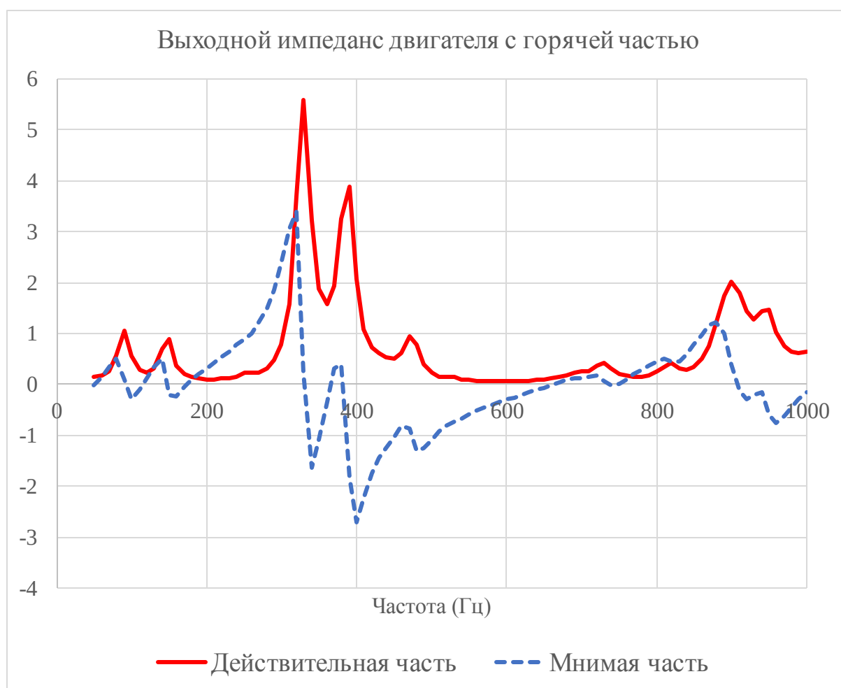
Рис. 14. Выходной импеданс двигателя с выпускными каналами и турбиной в ТКР
