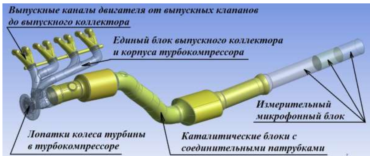
Рис. 12. Расчетная модель горячей части с выпускными каналами двигателя
