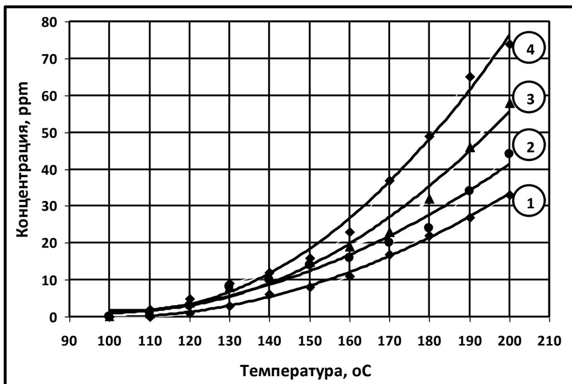
Рис. 1. Зависимость объема выбросов оксида углерода (CO) от количества асфальтового гранулята и температуры приготовления смеси:
