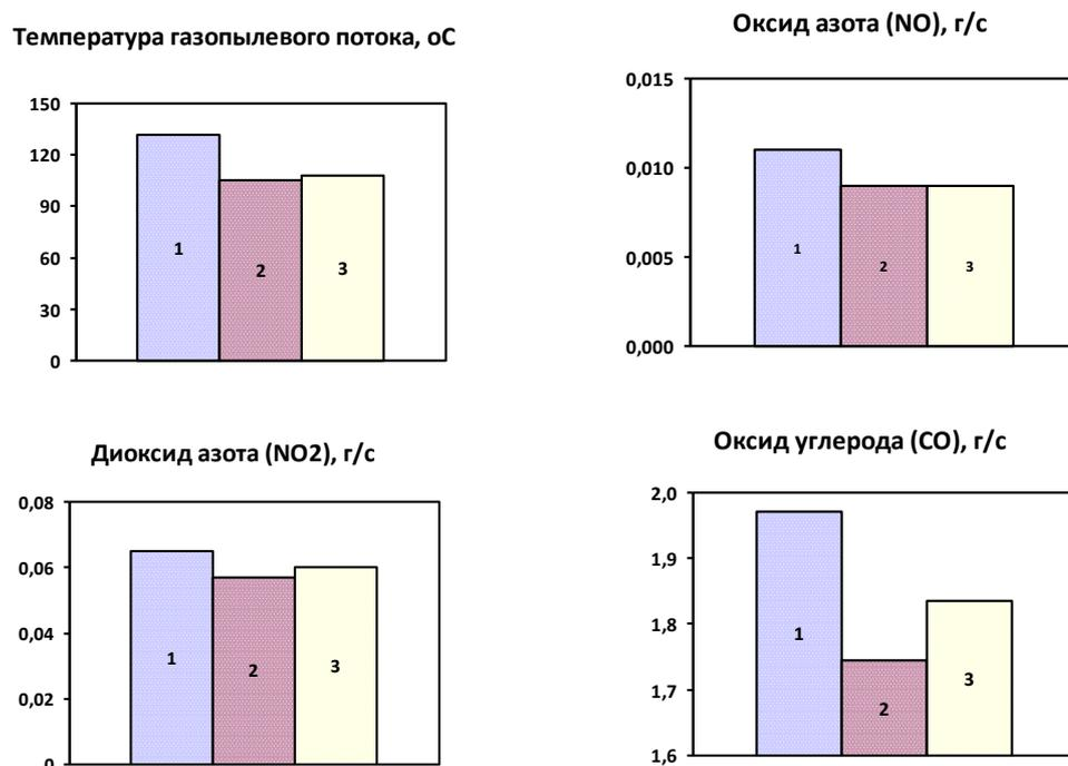
Рис. 3. Результаты измерения выбросов загрязняющих веществ при приготовлении мелкозернистой плотной асфальтобетонной смеси (тип «Б» марка «I») с гранулятом: 1 – без добавок; 2 – с добавкой «Evoterm J-1»; 3 – с добавкой «ДАД-1»
