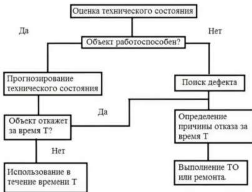
Рис. 2. Блок-схема отслеживания состояния транспортного средства
