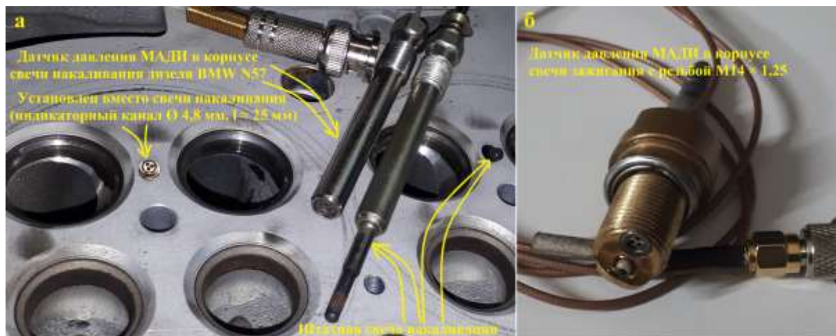
Рис. 1. Миниатюрный датчик давления, разработанный в МАДИ; а – в корпусе свечи накаливания дизеля, б – в корпусе свечи зажигания
