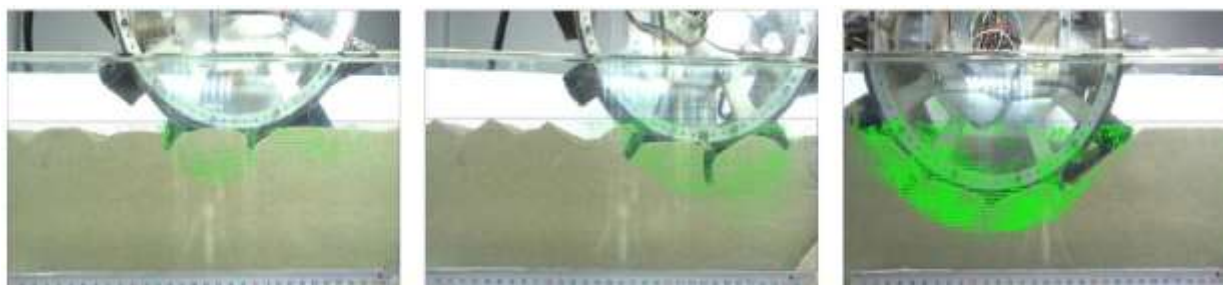
Рис. 3. Визуализация величины скорости движения грунта (интенсивность зеленых линий визуализирует относительную скорость движения грунта) при движении колеса с различным тяговым усилием и скоростью по слабосвязанному грунту
