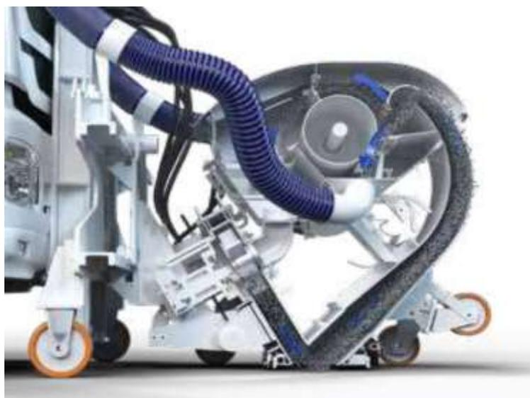
*Рис. 3. Дробеструйная очистка поверхности*
