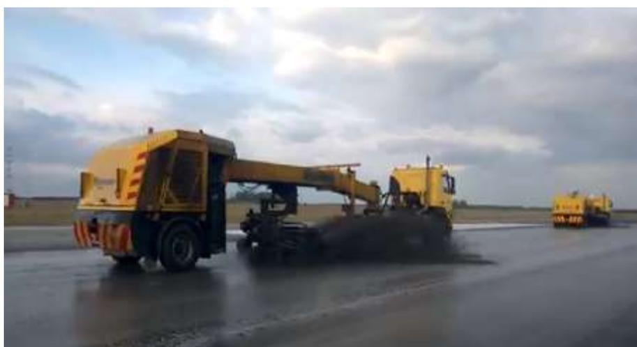
*Рис. 1. Использование щётчного очистителя для повышения эффективности очистки*
