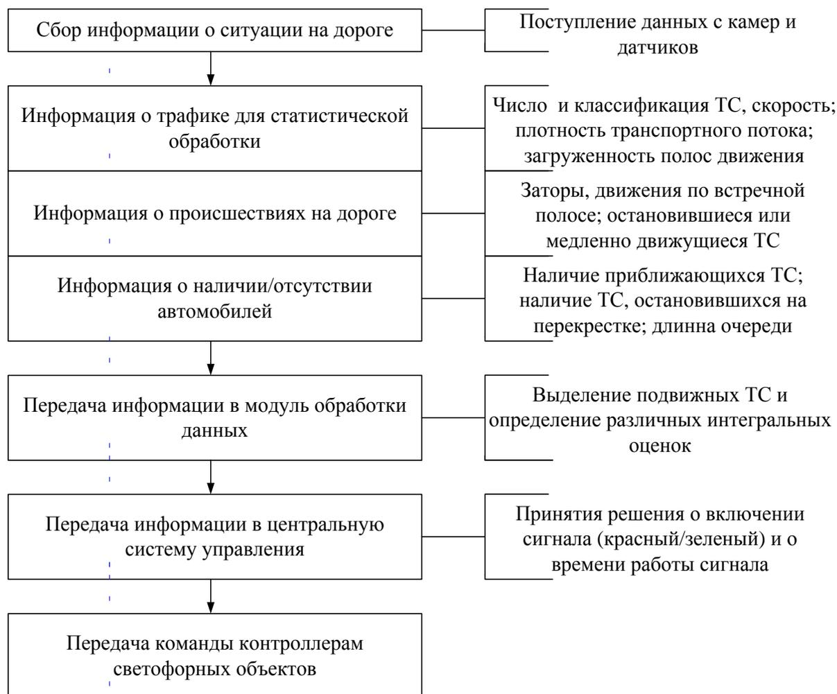
Рис. 3. Процедура работы системы «умный светофор»
