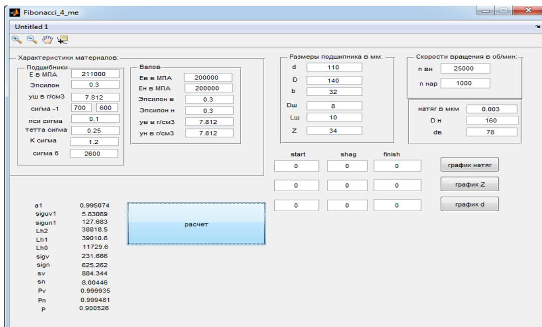
Рис. 2. Интерфейс пользователя программы расчёта долговечности межвального роликоподшипника
